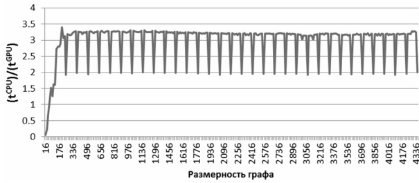
Рис. 5. Отношение времени работы ( t^{CPU}/t^{GPU} ) на центральном процессоре и параллельной реализации на видеоадаптере
